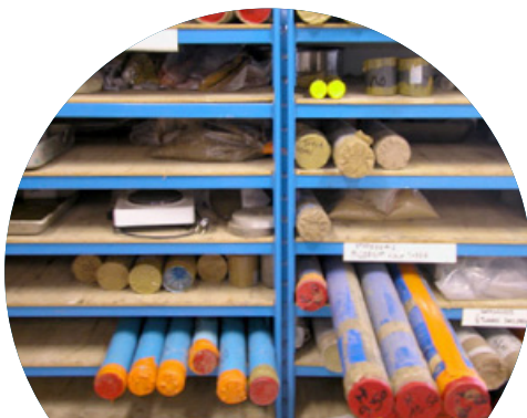
Conservation des échantillons de sol, roche et béton dans une salle à hydrométrie contrôlée
