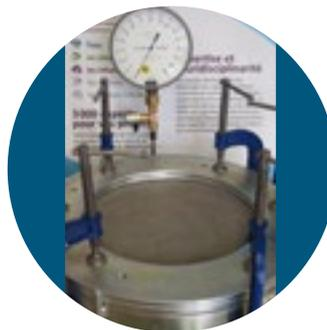
*Dispositif de mesure des caractéristiques de souplesse*
