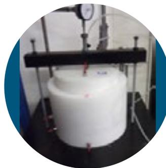
*Dispositif de mesure de gonflement et perméabilité sur GSB*
