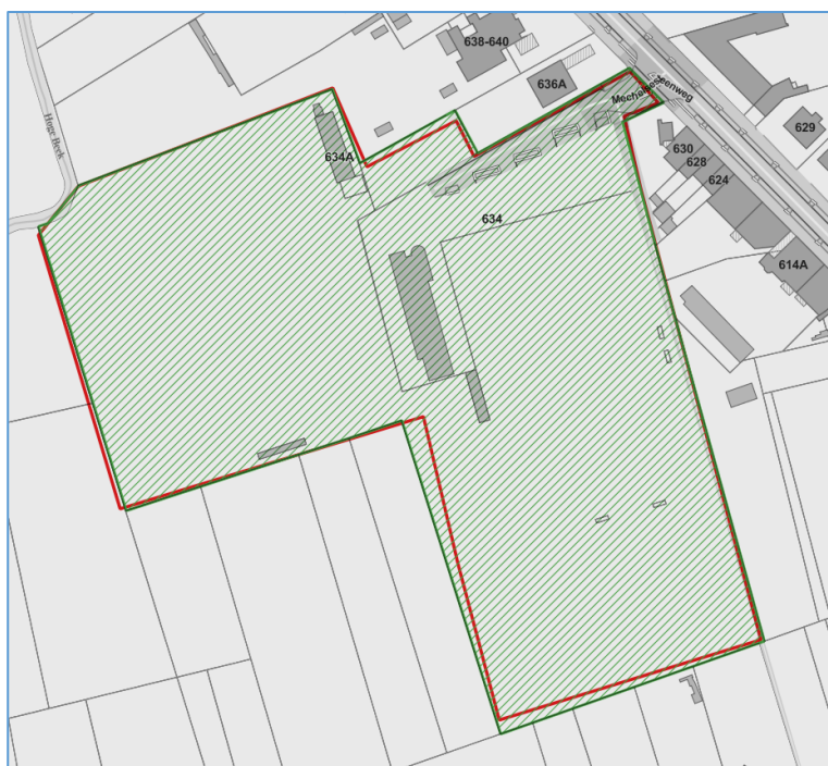
Figuur 3 - voorbeeld van een oorspronkelijk domein uit de dataset (rood) en de geautomatiseerde omzetting naar perceelsgrenzen (groen)
