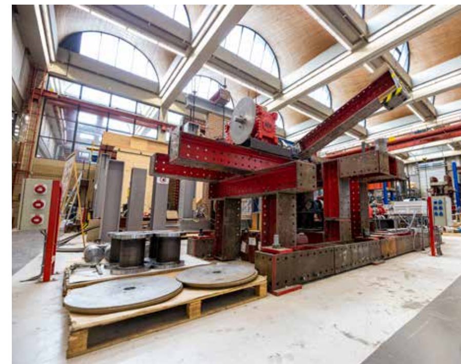
In het ontwerp van de proefopstelling wordt de eerste massa gevormd door een vliegwiel met een variabele as.
